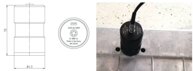
Abbildung 2: Schema und Beispiel Tastsonde
